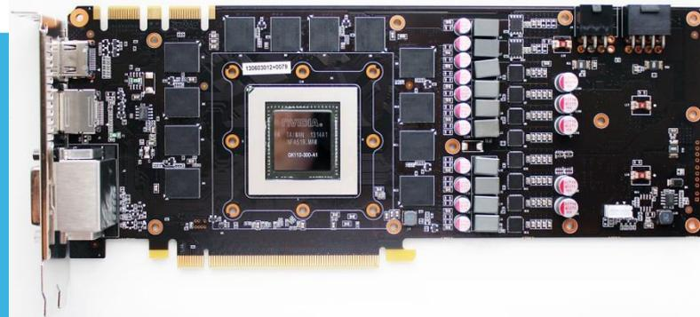
**Разъёмы.** Предназначены для подключения к видеокарте внешних устройств и для вывода на них видеосигнала. Все разъёмы делятся на две основные группы: цифровые и аналоговые. При аналоговом подключении качество изображения сильно зависит от множества факторов. Это часто искажает изображение, поэтому такие разъёмы вытесняются цифровыми интерфейсами.
